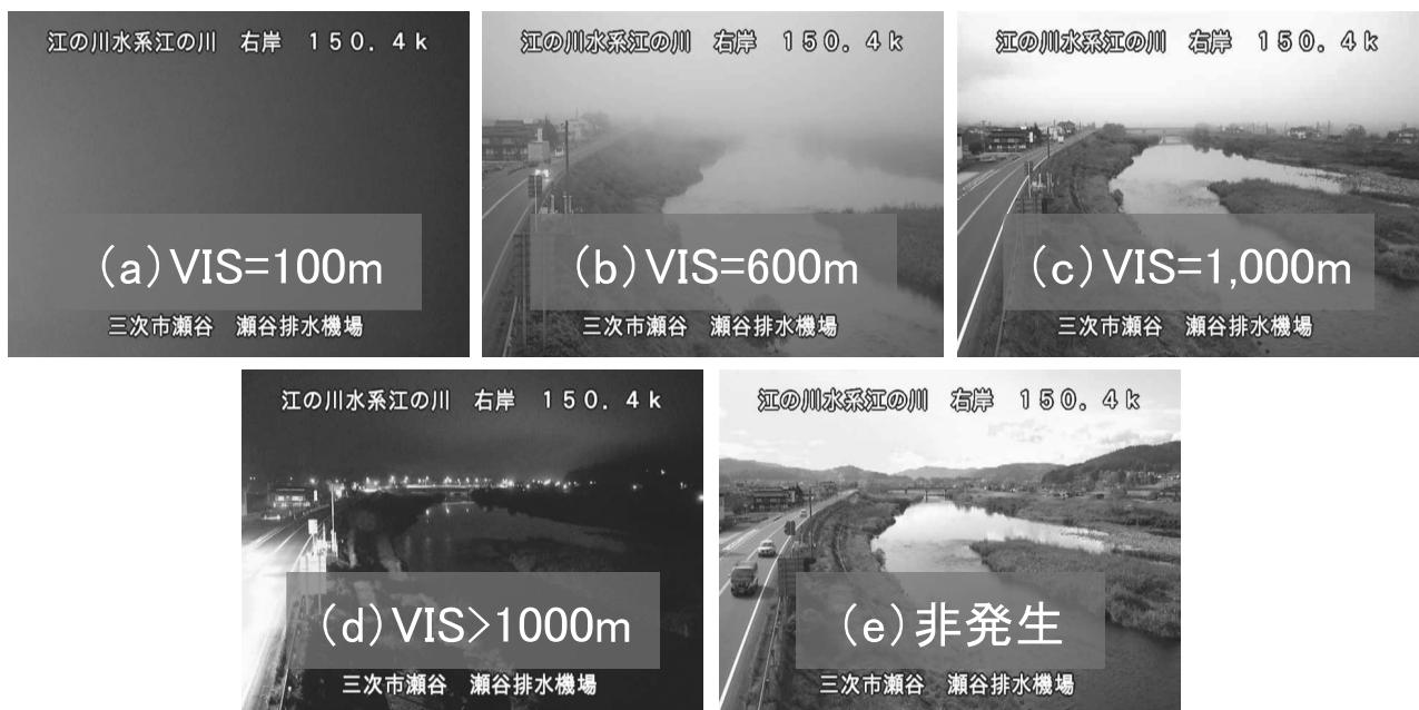
第4図 教師画像に使用した三次市瀬谷にある河川ライブカメラ画像 (<http://www.cgr.mlit.go.jp/miyoshi/>) の例。(a) 100m未満, (b) 100～600m, (c) 600～1,000m, (d) 1,000m以上, (e) 非発生の5クラスに視程(VIS)を分類した。
